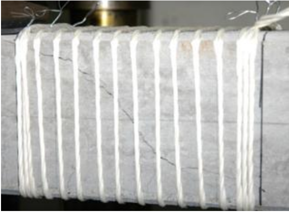
写真-3 斜めひび割れ状況 (No. 5)
