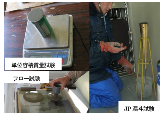
写真-1 試験状況写真
