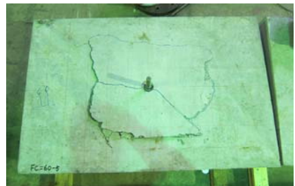
図 17 最終的なひび割れ状況 (No.3)
