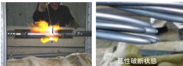
写真-8 間接加熱法
