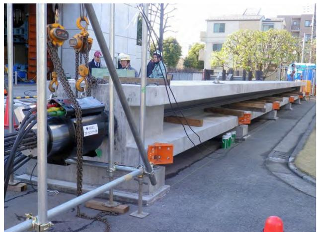
写真－5 外ケーブル緊張試験状況
