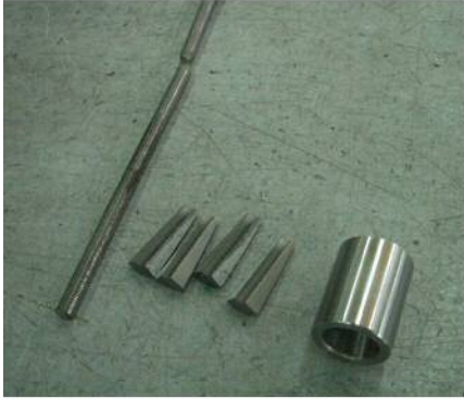
写真-5 破断後の定着具とPC鋼線
