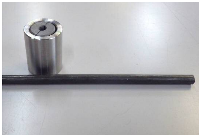
写真-4 \phi 7\text{mm} 用定着具とPC鋼線 7mm
