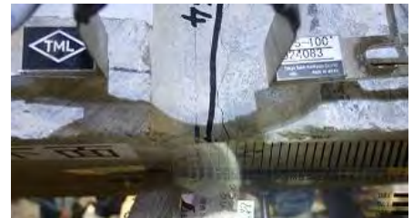
写真-4 ひび割れ発生時 (幅 0.08mm)
