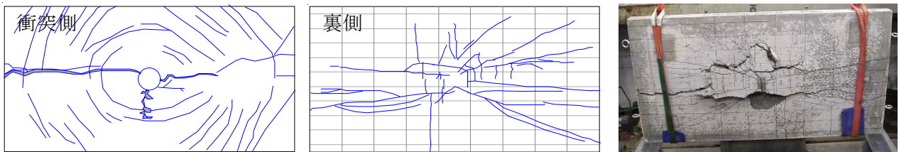
図-6 UFC-9-P の破壊状況 (13.0m/s, 写真は衝突速度 15.0m/s)
