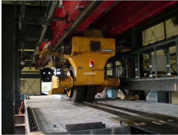
写真-1 輪荷重走行試験状況
