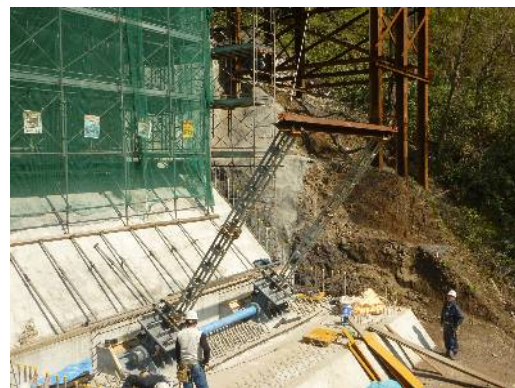
写真-2 ロアリング支承回転試験
