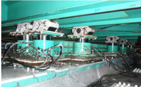
写真-3 ローラーと油圧ジャッキ
