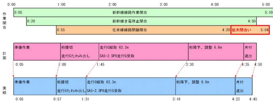
図-6 Gd1, Gd2 鋼桁架設時におけるサイクルタイムと実績
