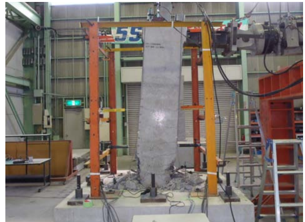
写真-2 PPC 2-2; 反力鋼棒有 (16 \delta y )
