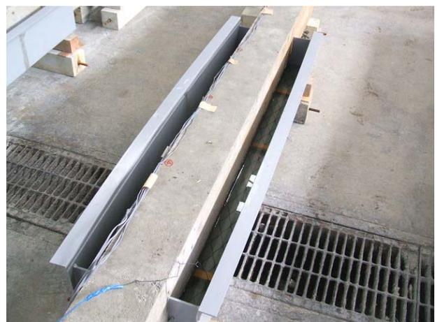
写真-1 脱塩工法の通電状況
