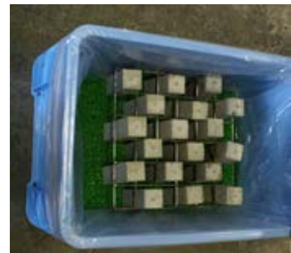
写真-3 試験体の浸漬状況
