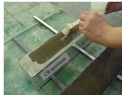
写真-2 塗布剤の塗布
