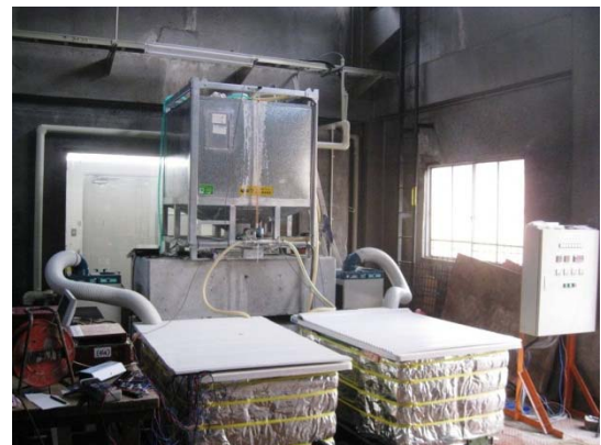
写真-3 乾湿繰返し試験 (試験装置の外観)
