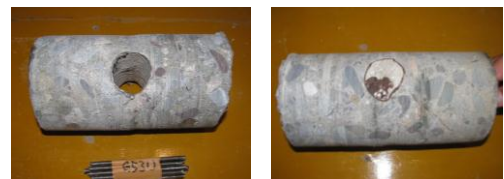
a) G53U(G5桁) b) G24L(G2桁) 写真-4 コア削孔による調査
