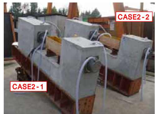
写真 - 2 定着具・接続具試験体外観
