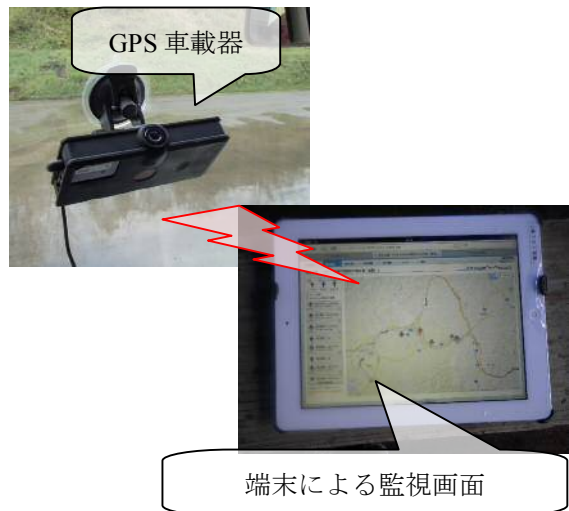
写真－2 アジテーター車に搭載したGPS とアジテーター車運搬管理状況
