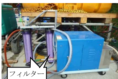
写真-4 フィルター設置状況
