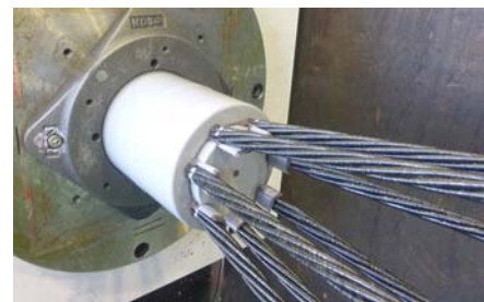
写真-4 試験後の固定定着具の状況
