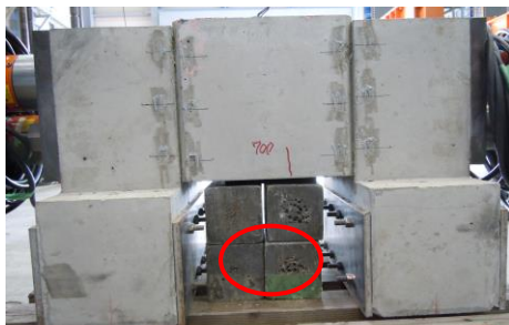
写真-1 中ブロック曲げひび割れ (供試体 No. 3 10-40-S)
