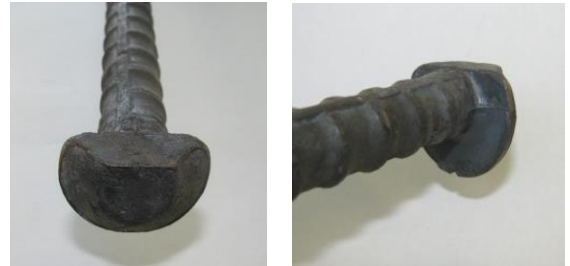
写真-1 鉄筋先端の加工形状
