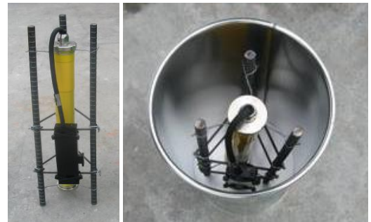
写真-2 RFID 収縮試験体の概要
