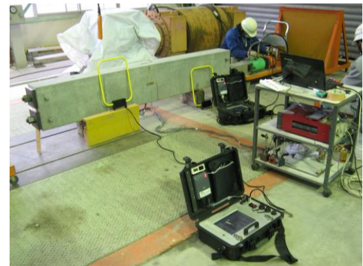
写真-3 緊張力導入時の測定状況
