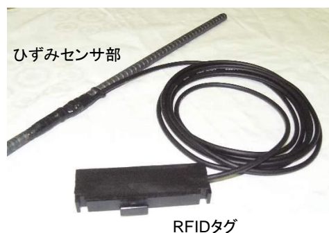
写真-1 RFIDを用いたひずみセンサ
