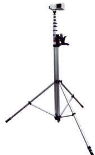
図-2 高所点検ロボットカメラ
