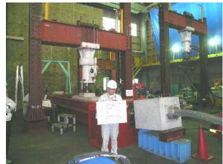
写真-1 フレットング疲労試験状況
