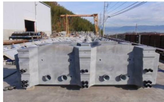
写真-2 プレキャスト中間横桁の製作状況
