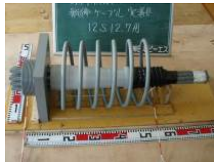
写真-9 主ケーブル定着部
