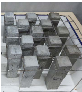
写真-3 供試体の空中乾燥
