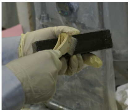
写真-2 供試体へ被膜剤の塗布
