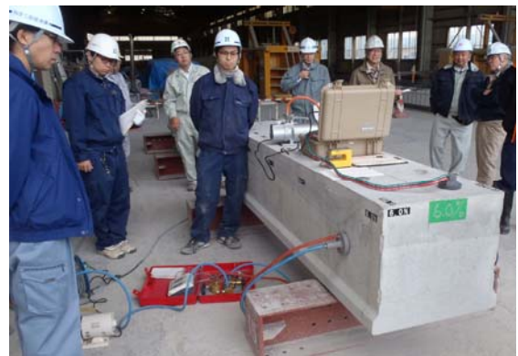
写真-2 表層透気性に関する調査状況
