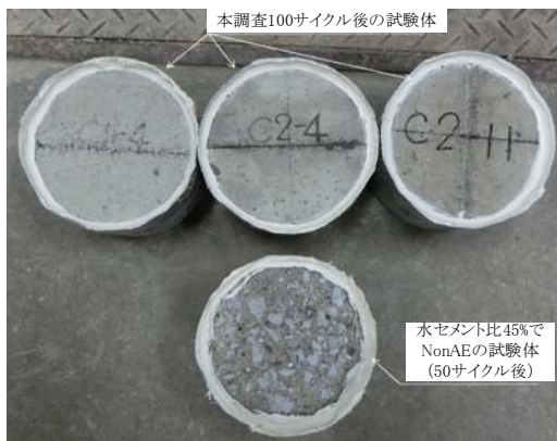
写真-3 スケーリング試験後の状況
