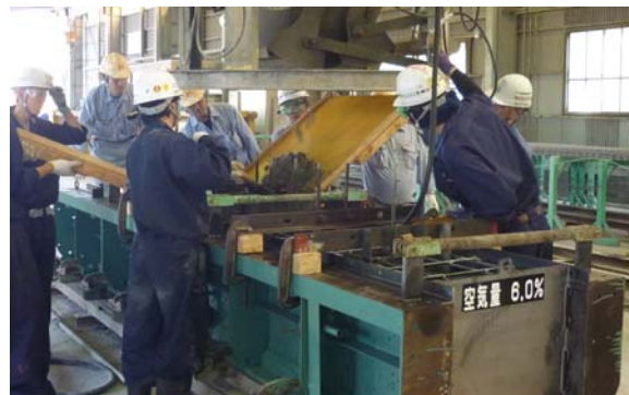
写真-1 新仕様 6.0%試験体の製作状況
