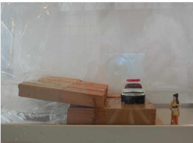
写真 1 自己起立防波堤の模型実験（起立前）
