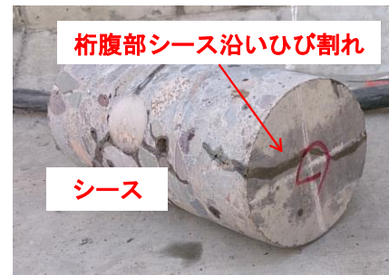
写真-2 桁腹部シース沿いひび割れ発生状況
