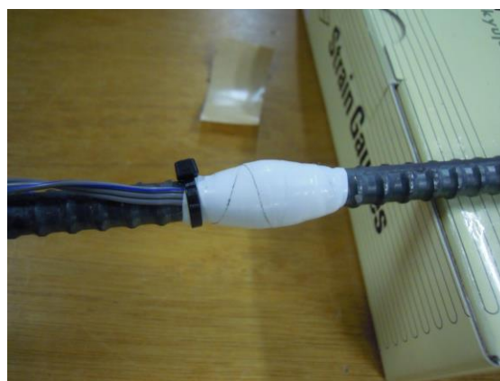
写真-1 防水加工された鉄筋
