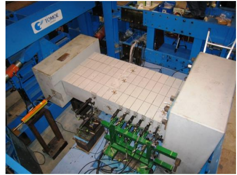
図-2 実験供試体セットアップ状況
