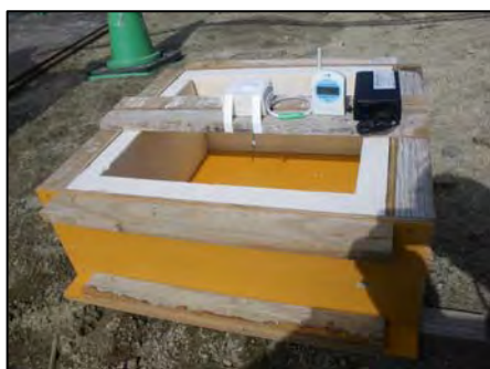
写真-1 上床版模擬供試体（型枠）
