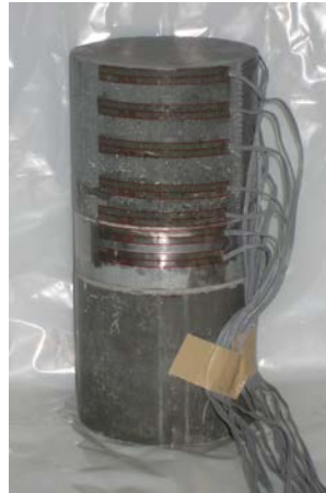
図-5 鋼板補強供試体
