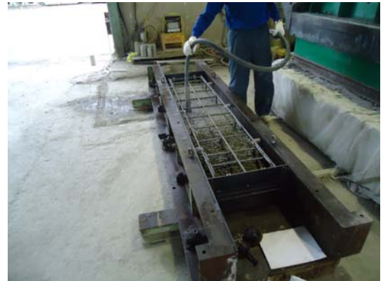
写真-2 プレキャスト床版供試体の作製
