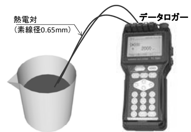
図-4 注入樹脂可使硬化時間測定方法
