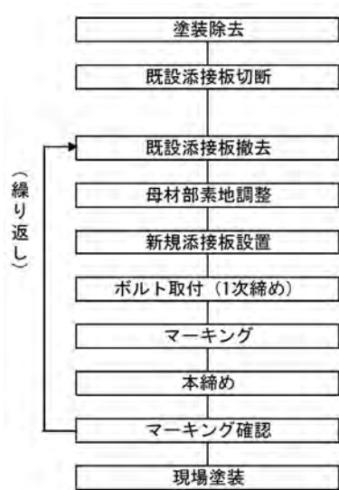
図-2 添接板取替えフロー
