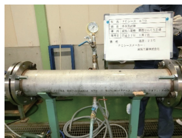
写真-1 外水圧試験の状況
