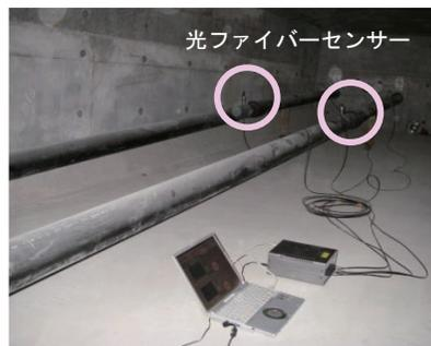
写真-6 外ケーブルの計測状況
