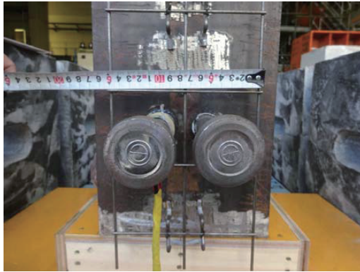
写真-1 溶接金網設置状況
