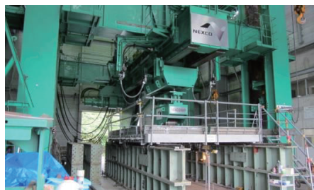
写真-2 輪荷重疲労載荷試験状況
