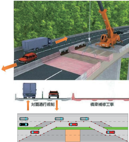
図-1 全断面の取替え例
