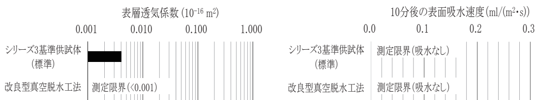
図-3 改良型真空脱水工法が表層品質に及ぼす影響 (シリーズ 3)
