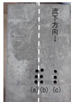
図-1 塩水・真水流下実験装置概要 写真-1 塩水・真水流下実験装置 写真-2 粉末試料採取位置
