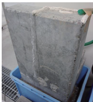
図-1 塩水・真水流下実験装置概要 写真-1 塩水・真水流下実験装置 写真-2 粉末試料採取位置
