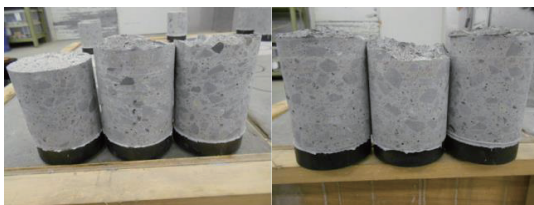
写真-1 付着試験体の破壊形状
