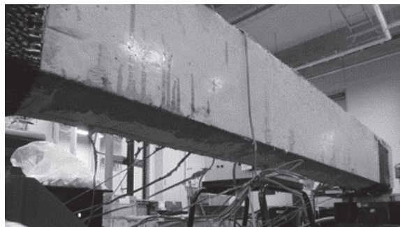
写真-1 BFRPロッドの緊張接着の状況
