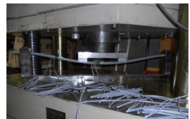
写真-2 2点集中荷重の状況
