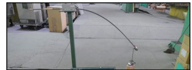
写真-1 片持ち荷重の状況
