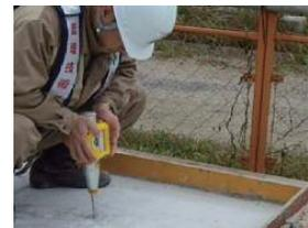
写真-4 表面硬度測定状況
