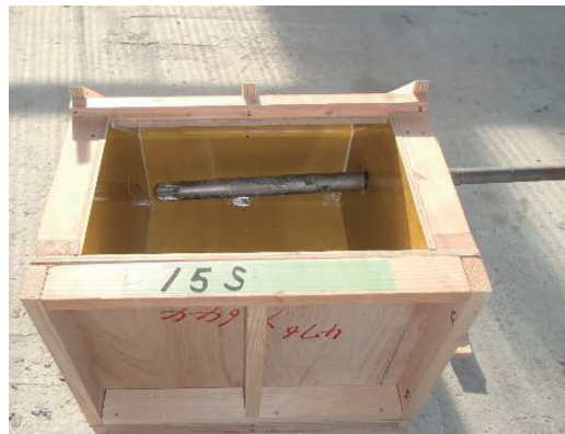
写真-2 試験体と水平バイブレータ
