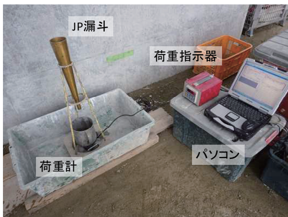
写真-1 自動質量計測方法の機材設置例
